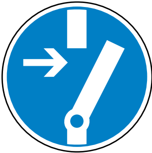
M14 Vor Arbeiten freischalten
